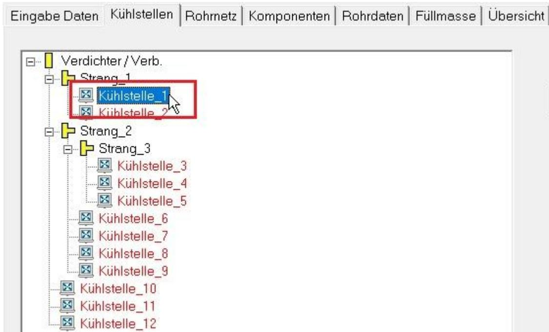
25. Geben Sie jetzt die Daten für die eingefügten Kühlstellen ein. Klicken Sie dazu mit der Maus auf die Kühlstelle oder Navigieren Sie einfach mit den Pfeiltasten.
