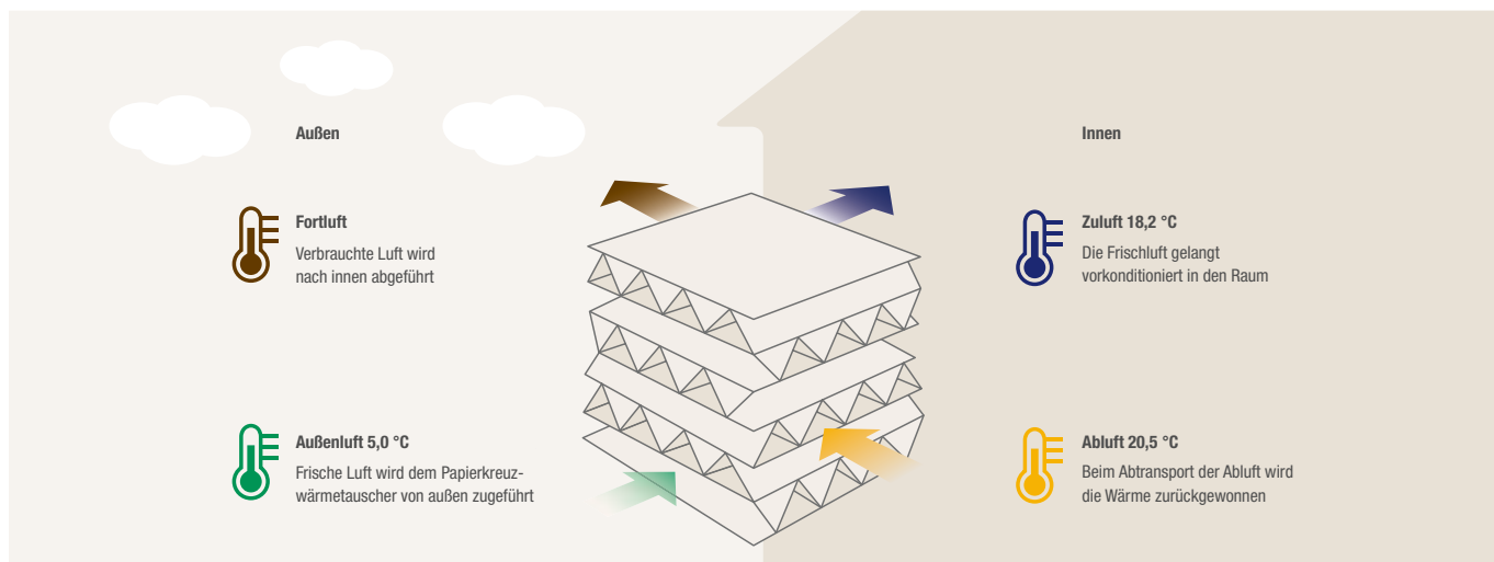
Die Struktur des Lossnay Papierkreuzwärmetauschers
